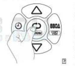
Если нажать кнопку «РЕЖИМ», то вместо заданного значения температуры нагрева на дисплее отобразится установленное значение скорости нагрева.
