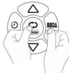
В режиме нагрева одновременно нажмите и удерживайте нажатыми в течение 3-х секунд кнопки «РЕЖИМ» и «ВВОД». Включится режим установки скорости нагрева. С помощью кнопок  $\Delta$  и  $\nabla$  установите нужное значение и нажмите кнопку «ВВОД». Используйте ту же комбинацию кнопок для возвращения в исходный режим.
