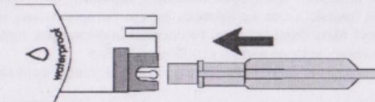
Поверните датчик против часовой стрелки и потяните на себя, чтобы достать его из корпуса.
