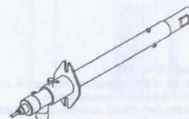
Рис.2б Запальник. С комплекта ЗЗУ-МК (МКС)
