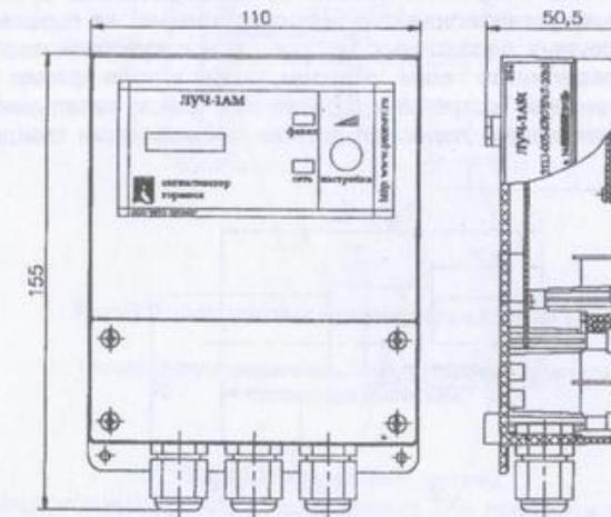
Рис.4 Сигнализатор горения ЛУЧ-1АМ (ЛУЧ-КЭ)
