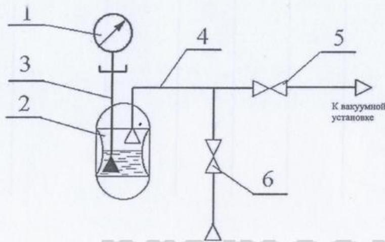
1 – образцовый манометр; 2 – сосуд с жидкостью; 3, 4 – трубы;
