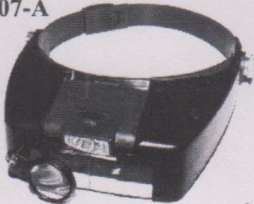
Увеличение: Три линзы – две прямоугольных линзы размером 88×29 мм, одна круглая монокулярная линза диаметром 29 мм. Наборная кратность ×1,8; ×2,3; ×3,7; ×4,8. Материал линз: акриловый полимер. Все линзы этой серии налобных луп взаимозаменяемы.
