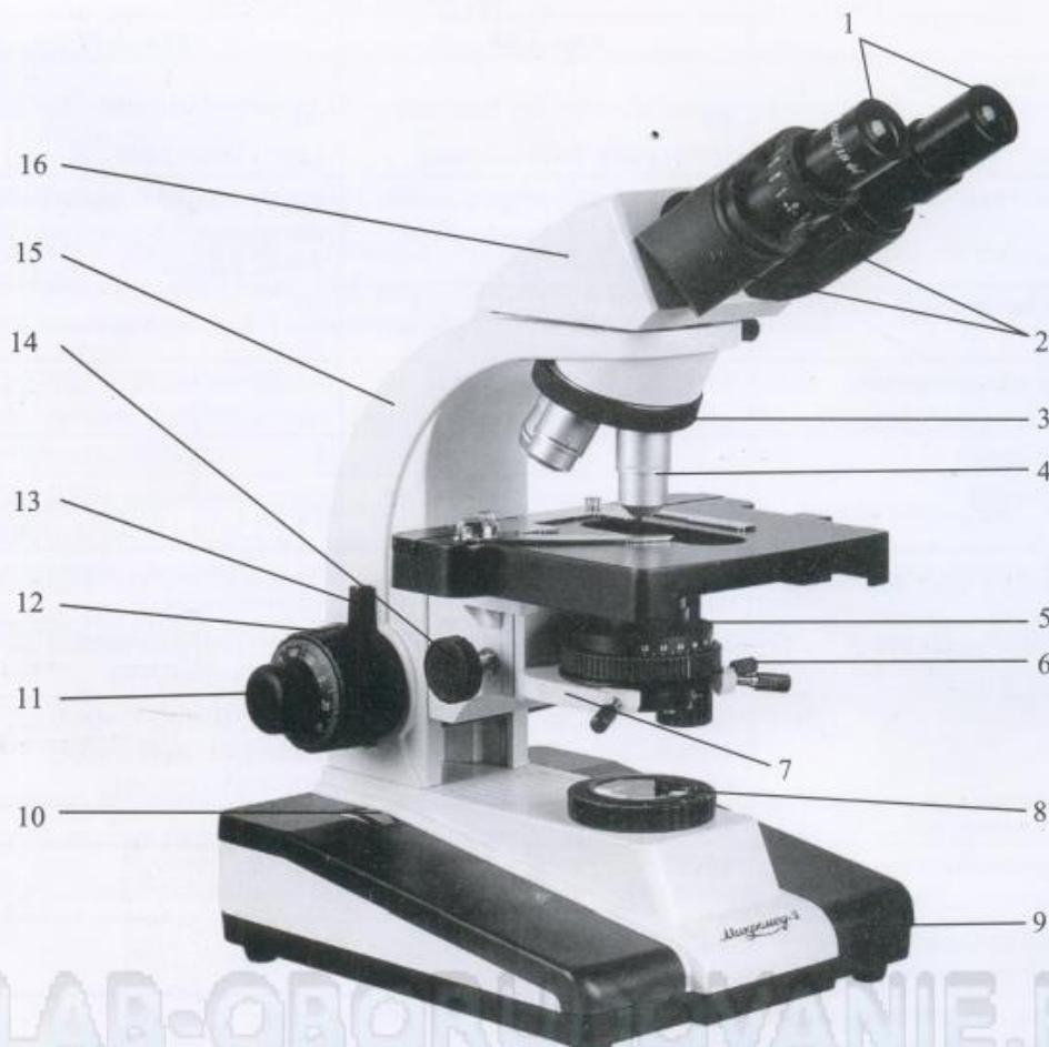
1 – окуляры; 2 – окулярные тубусы; 3 – револьверное устройство; 4 – объективы; 5 – конденсор Аббе; 6 – винт фиксации конденсора в кронштейне; 7 – кронштейн конденсора; 8 – вспомогательный объектив; 9 – основание микроскопа; 10 – рукоятка регулировки яркости горения лампы; 11 – рукоятка тонкой фокусировки; 12 – рукоятка грубой фокусировки; 13 – механизм блокировки грубой фокусировки для быстрой перенастройки; 14 – рукоятка перемещения кронштейна конденсора; 15 – бинокулярная визуальная насадка.
