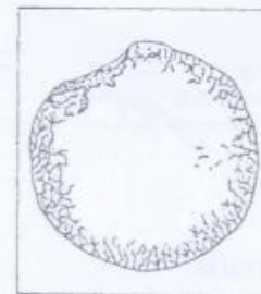
Лепешки, не выдержавшие испытания на равномерность изменения объема
