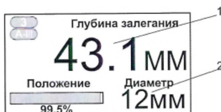
Рисунок 29. Определение диаметра и глубины залегания арматуры, вывод результата измерения.
