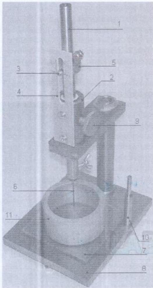
соприкасая пестик с пластинкой, на которой расположено кольцо. При отклонении от нуля шкалу прибора соответствующим образом передвигают. Кольцо и пластинку перед началом испытаний смазывают тонким слоем машинного масла. Кроме того, проверяют чистоту, поверхности и отсутствие искривлений иглы.
