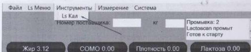
Открывается программный инструмент для калибровки. Оператор выбирает COM-порт, и нажимает кнопку Start. После этого вводит значения параметров в полях. С помощью кнопки - Измерение, начинается новое измерение образца в режиме калибровки.
