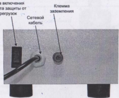
Рис 2. Задняя панель мельницы ЛМ201
