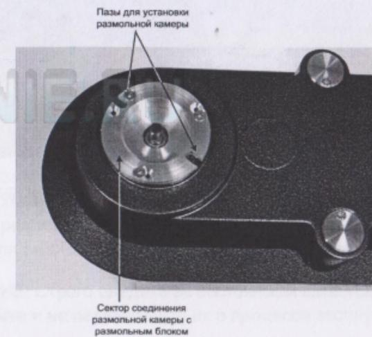
Рис 4. Рабочий блок мельницы.
