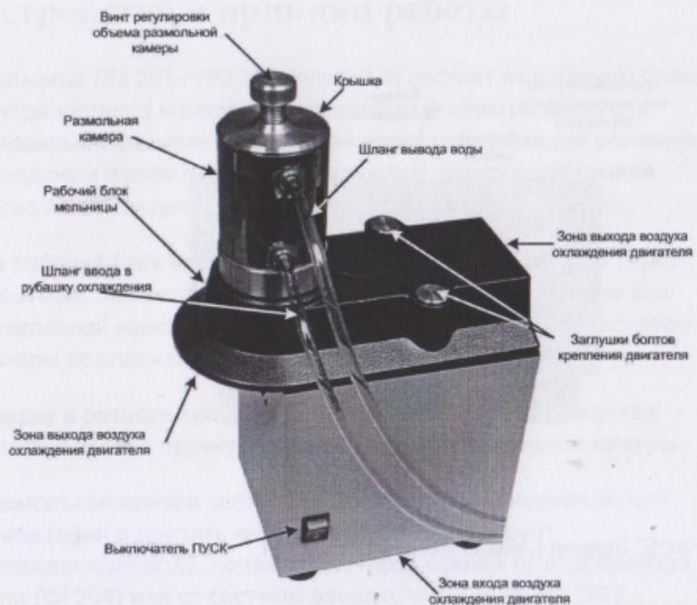
Рис 1. Устройство мельниц ЛМ201 и ЛМ202.
