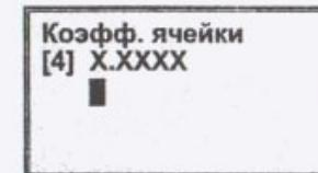
Набирают на клавиатуре значение постоянной ячейки и нажимают кнопку «ВВОД». Значение постоянной ячейки появится в нижней строке.
