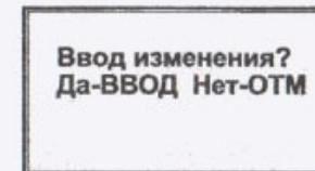
Нажимают кнопку «ВВОД» для расчета и ввода в память прибора постоянной ячейки.
