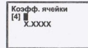
Набирают на клавиатуре значение УЭП контрольного раствора в мкСм/см, полученное при измерении на эталонном кондуктометре и нажимают кнопку «ВВОД». Введенное значение УЭП появится в верхней строке.
