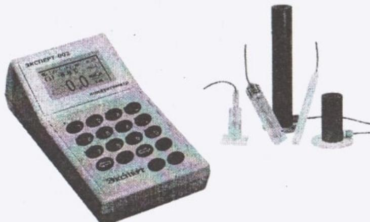
Рисунок 1 – Внешний вид кондуктометра
