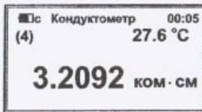
При повторном нажатии кнопки «R» прибор вернется в режим измерения УЭП и температуры.
