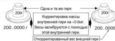
1 Откалибруйте весы с помощью внутренней гири (нажатием одной клавиши). Пример: 200.000 г корректируется на +0.6 мг (200.0006 г).
