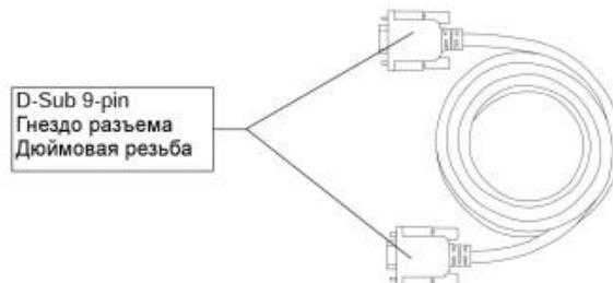
Водонепроницаемый кабель RS-232C (AX-KO2737-500) приобретается отдельно в качестве опции, если последовательный интерфейс RS-232C используется с классом защиты IP-65.
