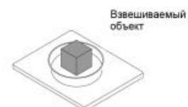
Нажатие клавиши **RE-ZERO** приводит к обнулению весов, если значение массы находится в пределах  $\pm 2\%$  НПВ относительно нулевого значения при включении весов. При этом включается индикатор **ZERO** . Если масса превышает  $+2\%$  от значения НПВ, он будет вычен, как масса тары. В этом случае на дисплее включаются индикаторы **ZERO** и **NET**.
