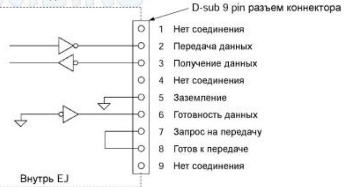
Интерфейс является устройством типа DCE (устройство передачи данных).
