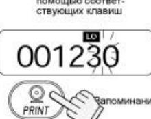
8. Нажмите клавишу **PRINT**. На дисплее последовательно появится индикация **end** и **Unit**.
