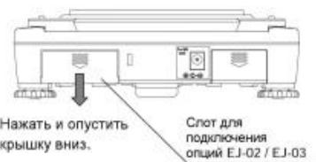
4. Закрепите EJ-03 с помощью винтов, входящих в комплект опции.
