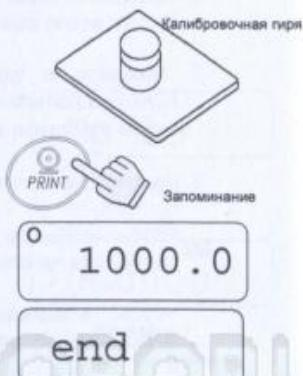
7. На дисплее появится индикация **end**. Снимите гирю с чашки и нажмите клавишу **CAL** или **MODE** для возвращения в режим взвешивания.
