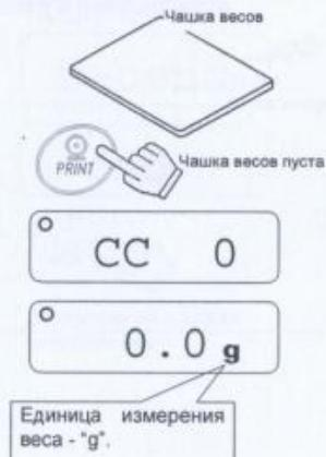
5. Поместите на чашку весов груз, масса которого соответствует значению, показанному на дисплее. Нажмите клавишу **PRINT** для того, чтобы выполнить взвешивание. На дисплее на несколько секунд появится результат взвешивания.
