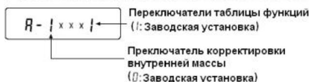
Установите переключатели таблицы функций и корректировки внутренней массы в положение 1, как показано на рисунке выше, с помощью следующих клавиш:
