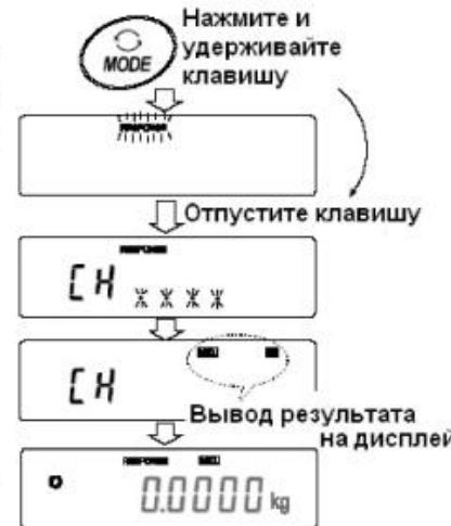
3. После автоматической регулировки на дисплее весов появляется обновленная индикация отклика, и весы возвращаются в режим взвешивания. Индикация отклика некоторое время остается на дисплее.
