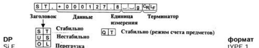
Этот формат используется, когда периферийные устройства не могут получать данные в формате A&D. Если используется принтер AD-8121, установите для него режим MODE 3.
