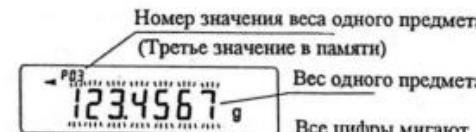
4. Выберите номер значения массы образца с помощью следующих клавиш: **RE-ZERO** - Используется для увеличения номера значения массы образца на единицу
