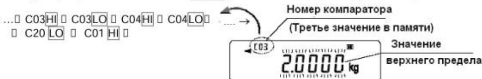
Значение массы тары: значение параметра «Запоминание данных (dAtA)» равно 5. Каждый раз при нажатии клавиши **MODE** дисплей изменяется следующим образом:
