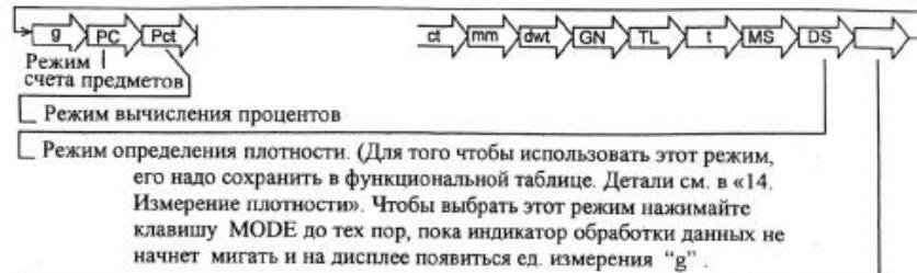
Единицы измерения или режим взвешивания могут быть выбраны и сохранены в таблице функций, как это описано на следующей странице. Если режим взвешивания (или единица измерения) был отключен, этот режим (единица измерения) будет исключен из списка. Для выбора единицы измерения или режима взвешивания нажмите клавишу MODE.
