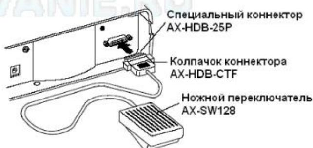
Внешний входной коннектор (AX-HDB-25P/CTF) и ножной переключатель (AX-SW128) приобретаются отдельно.
