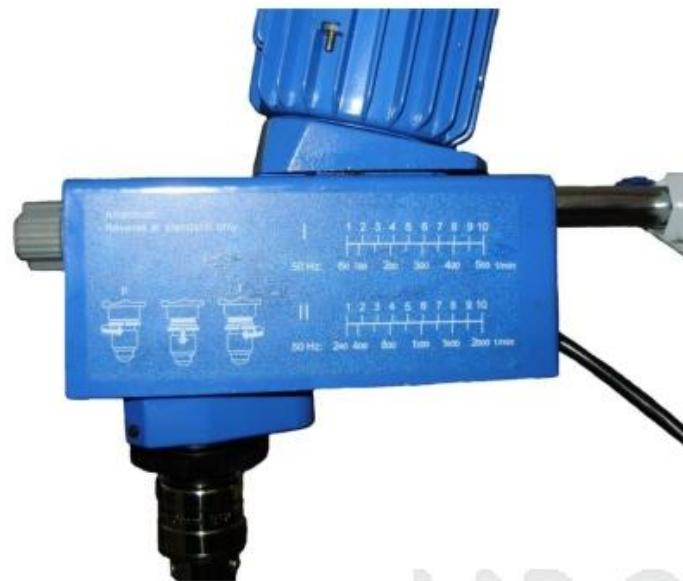
Зажимной патрон и вращательный вал служат для фиксации стержня перемешивающей насадки с диаметром до 10 мм. Отверстие в верхней части блока двигателя позволяет продвинуть стержень перемешивающей насадки вверх для удобства смены посуды с рабочей супензией. Эта процедура должна осуществляться только в выключенном состоянии прибора.
