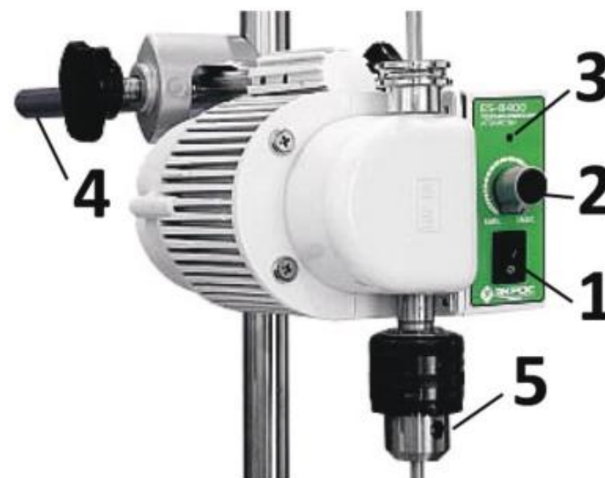
Рисунок 1 - Перемешивающее устройство ES-8400 1 – сетевой выключатель, 2 – регулятор скорости, 3 – индикатор питания, 4 – шток, 5 – патрон.
