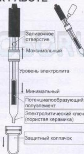
4.3 Залить\* в электрод через отверстие, расположенное в его верхней части, раствор KCl концентрацией 3,0M, 3,5M или на-
