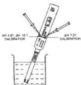
Одноточечная калибровка: погрузите электрод в буферный раствор с pH, близким к исследуемым растворам и подкрутите с помощью отвертки калибровочный винт "pH 7,0" (см. рис)
