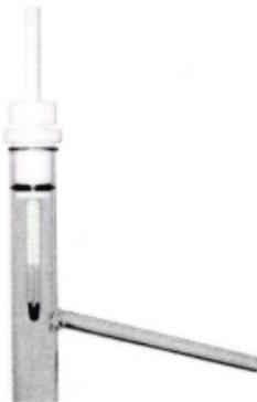
Рис. 3. Центрирующая втулка для установки термометра.
