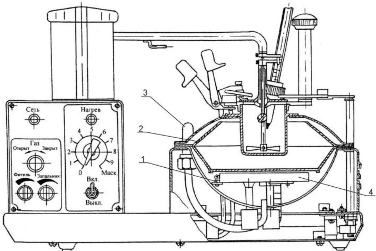
Рисунок 8- Аппарат ТВ3 в комплекте с жидкостной баней
