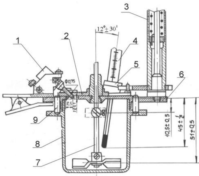
Верхний торец тигля должен прилегать к внутренней поверхности крышки по всей окружности. Максимальный зазор по диаметру между бортиком крышки и тиглем не более 0,36мм.
