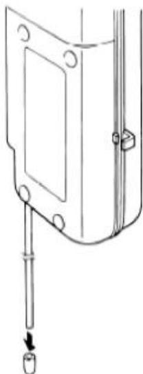
(2) Погрузите кончик пробоотборной трубы в воду. Затем сожмите и отпустите пробоотборную грушу. Вода будет затянута в камеру образца.
