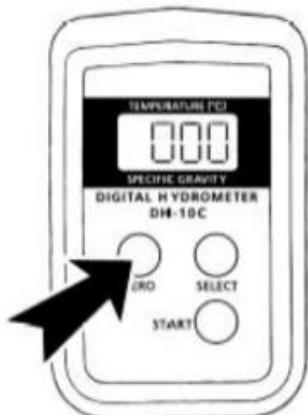
(5) Установка нуля завершена. Выньте пробоотборную трубку из воды и сожмите пробоотборную грушу, чтобы слить воду из камеры образца.
