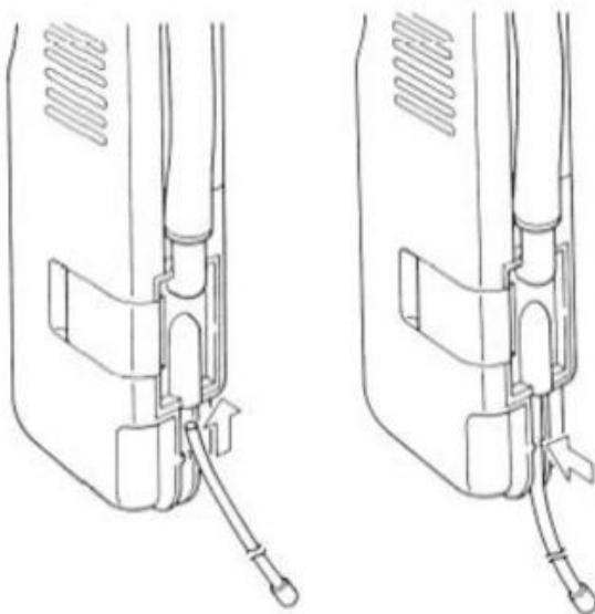
(1) Введите пробоотборную трубку в отверстие, находящееся в нижней части камеры образца, до упора.
