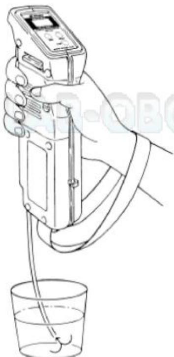
(3) Убедитесь, что камера образца заполнилась водой. Если в камере образца присутствуют пузырьки воздуха, то при помощи пробоотборной груши заново заполните водой камеру образца.
