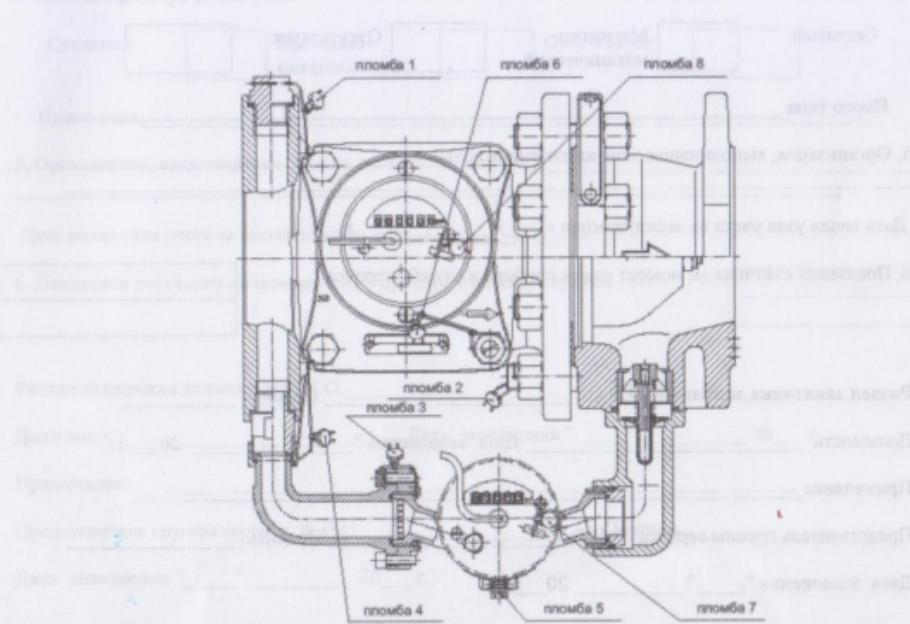
Рис. А2. Внешний вид счётчиков воды ВСХНКд и чертёж опломбировки навесными пломбами
