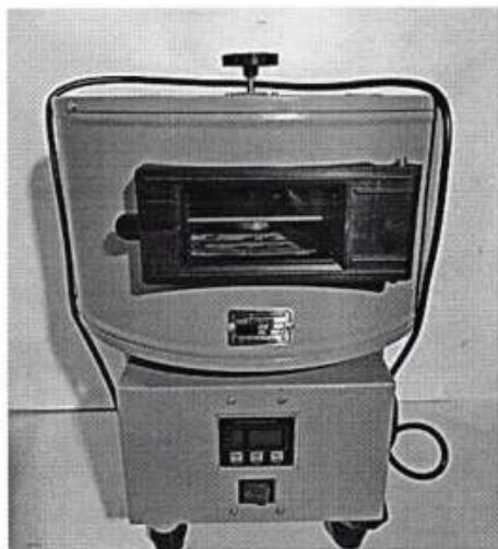
Рисунок 1 – Общий вид установок воздушно-тепловых для измерений влажности зерна и зернопродуктов СЭШ-10ЭМ
