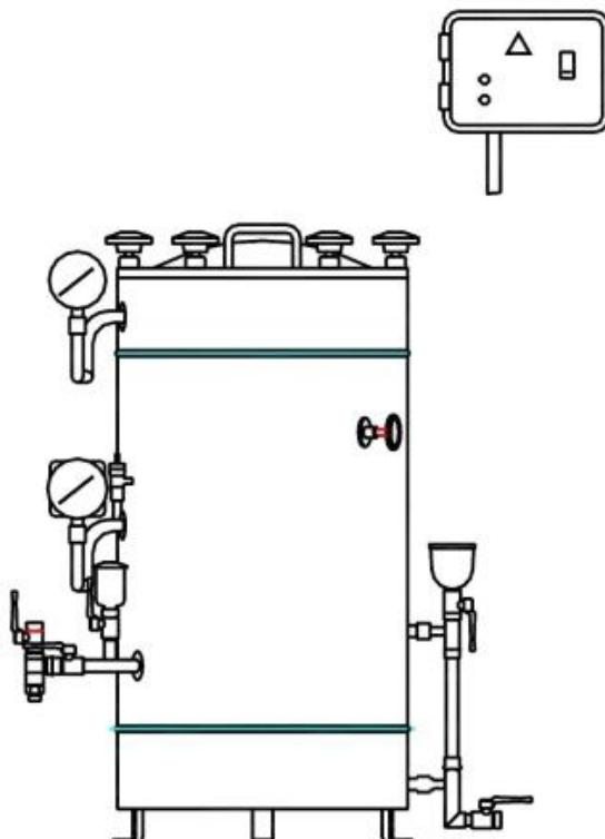
Стерилизатор предназначен для стерилизации водяным насыщенным паром под давлением изделий медицинского назначения из металлов (хирургические инструменты и др.), стекла (посуда и др.), резин (хирургические перчатки и др.), изделий из текстильных материалов (хирургическое белье и др.), воздействие пара на которые не вызывает изменения их функциональных свойств.
