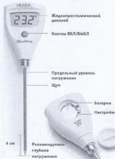
Для включения Checktemp® нажмите клавишу ON/OFF. После включения все символы ЖК дисплея отобразятся в течение 1 с и автоматически запустится процедура контроля калибровки CalCheck®. Появление на экране надписей "CAL" и "0" означает, что характеристики Checktemp® находятся в пределах допуска и прибор готов к работе.
