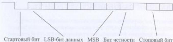
Рисунок 7.1 Последовательность передачи бит данных
