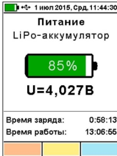
В нижней части дисплея выводятся текущие время заряда (увеличивается во время заряда аккумулятора) и время работы (увеличивается при работе от аккумулятора), позволяющие оценить время, оставшееся до окончания заряда или до момента разряда аккумулятора прибора.
