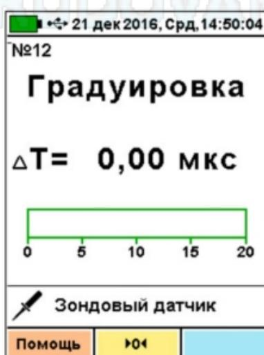
Произвести установку нуля датчика. После этого показания прибора будут пропорциональны влажности материала.
