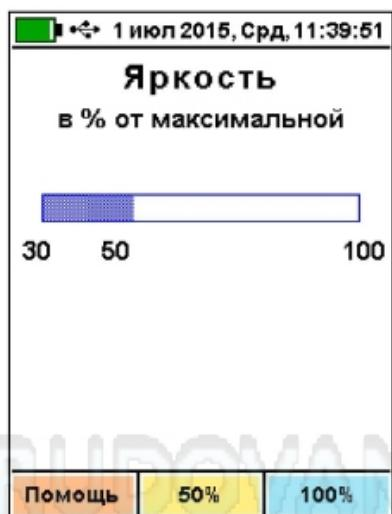
Следует иметь в виду, что при увеличении яркости возрастает потребляемая прибором мощность и, следовательно, снижается время автономной работы от аккумулятора. Продолжительность работы до разряда аккумулятора при яркости 30% больше, чем при 100% примерно в два раза.
