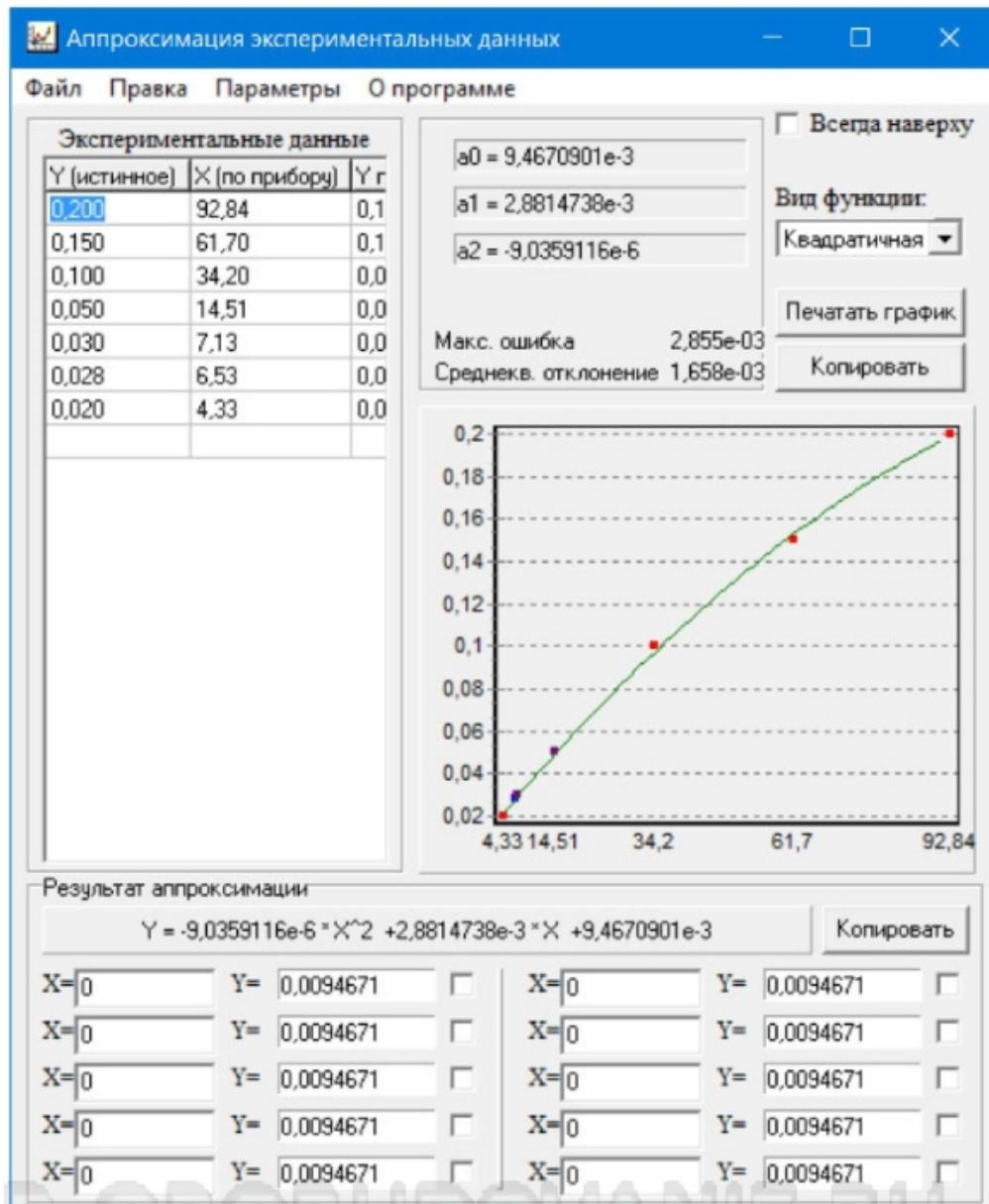
Значения полученных коэффициентов полиномов устанавливаются индивидуально для каждого вида материала. Меню редактирования коэффициентов вызывается нажатием функциональной кнопки «Коэфф.» в меню «Материал». Процедура установки коэффициентов изложена в п 1.4.4. Кроме того, коэффициенты можно вводить, используя программу связи с компьютером (см. Приложение А).
