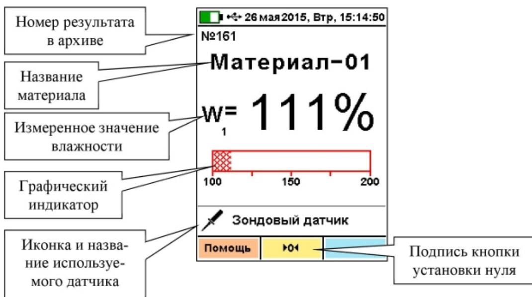
**Важно:** Для получения правильных результатов измерений необходимо периодически устанавливать ноль датчика, нажимая функциональную кнопку установки нуля «►0◄». При этом чувствительный элемент датчика должен быть удален от измеряемого материала и других посторонних предметов на расстояние не менее 20 см.
